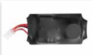
EM-VWF3: Frequenzweiche für die Mittel-/Hochtöneinheit mit 12 dB Filter @ 600 / 5700 Hz
