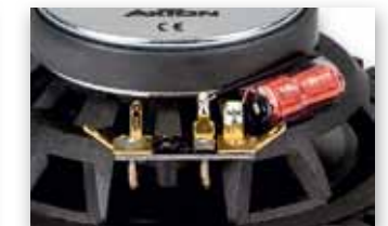
Weiche an der Korbrückseite
