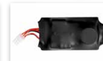
Frequenzweiche für die Mittel-/Hochtöneinheit
